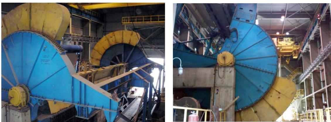
Рис. 1. Вагонопрокидыватель ВБС-93АМЛ
