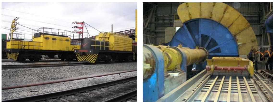
Рис. 2. Вагонотолкатель ВТ-4Л(д) (слева) и машина дробильная молотковая МДМ-2500(справа)
