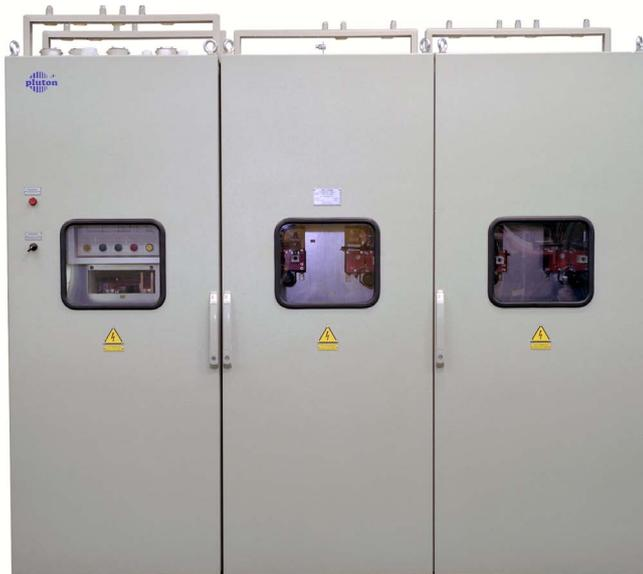
Распределительные устройства питания контактного рельса предназначены для питания контактного рельса тупика без канавы, тупика с канавой, коммутации цепи дроссель главного пути – дроссель тупика (участок путей технического осмотра). Обеспечивают подвод и распределение электроэнергии напряжением 825 В с номинальным током 4000 А.
