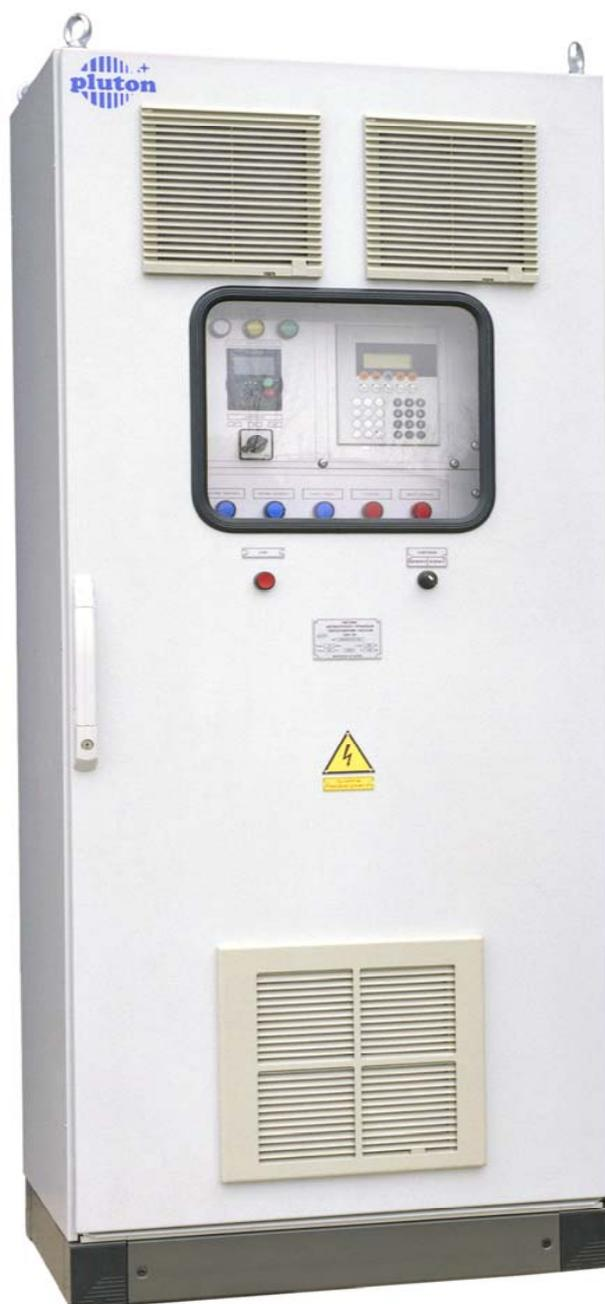
Шкаф системы автоматического управления насосной установкой ШСАУ-НУ предназначен для автоматического, экономичного управления электроприводами насосной установки различного назначения, вида и мощности с одним или несколькими насосами. Пределы мощности одного насоса 1,5...160 кВт., количество насосов не ограничено.
