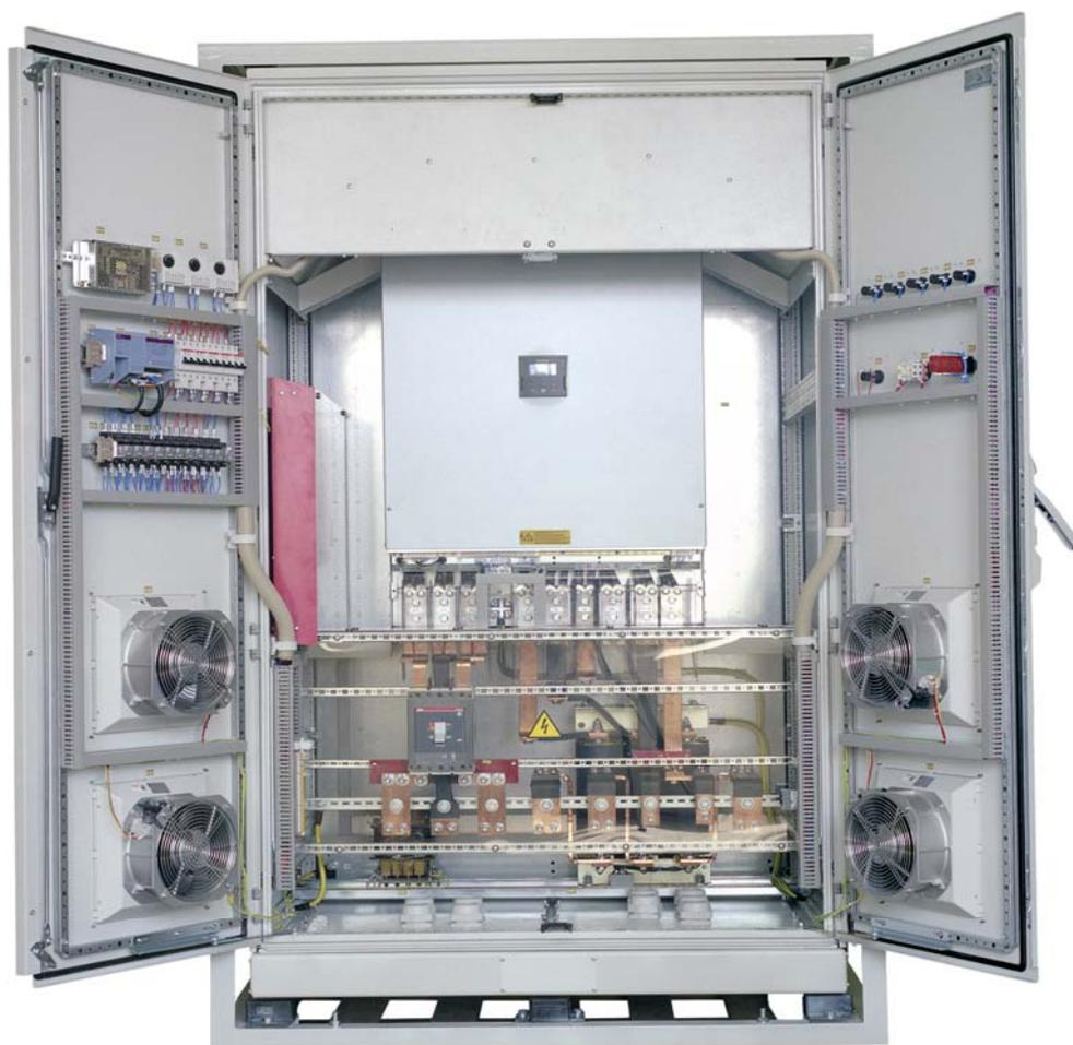
Преобразователи частоты шкафного исполнения серии VSI PN - это преобразователи с промежуточным контуром напряжения, выполненные на IGBT-транзисторах с широтно-импульсной модуляцией. Они преобразуют систему трехфазного тока с постоянной частотой и амплитудой в систему трехфазного тока с переменной частотой и напряжением.
