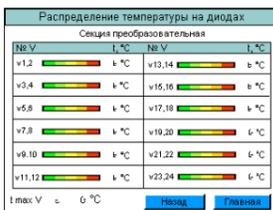
Промышленный контроллер PP65 с функцией визуализации. Основные «окна» панельного контроллера PP65
