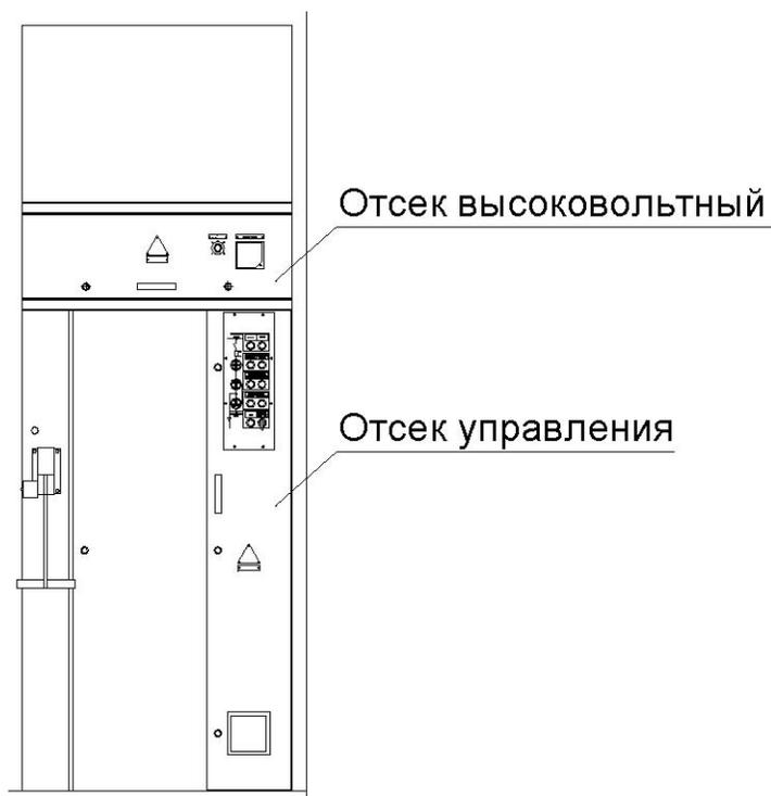
1. Производится демонтаж старой панели с кнопками, переключателями и реле, которая расположена справа от двери РУ-600. Демонтируются старые клеммные блоки, расположенные за этой панелью. На освободившееся место болтами крепится отсек управления со своей дверью.
