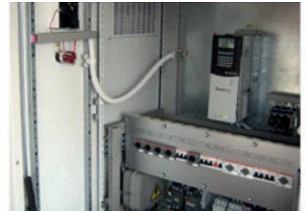
Поставка для компании по производству промышленного оборудования ООО «Спецмонтажмодуль» (г. Марганец, Украина) электрооборудования манипулятора газовой резки МГР-1400, в том числе асинхронный привод с преобразователем частоты
